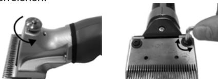
Legen Sie das neue Obermesser in die Kegelstifte des Mitnehmers, danach geben Sie einige Tropfen Öl auf die geschliffenen Flächen. Nun schieben Sie das neue Untermesser zwischen die gelösten Schrauben bis zum hinteren Anschlag. Ziehen Sie nun die beiden Schrauben mit dem beiliegenden Schlüssel fest. Drehen Sie die Maschine um und nehmen Sie die Einstellung der Maschine wie unter 1.1 beschrieben vor.
