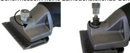
Legen Sie das neue Obermesser mit seinen vorhandenen Langlöchern auf die ovalen Zapfen des Scherkopfes. Das Untermesser wird nun auf die Bolzen gelegt. Schieben Sie die Flachrundschaube in das Vierkantloch des Untermessers. Drehen Sie die Maschine wieder in die seitliche Lage, stecken Sie die Feder auf die Flachrundschaube und schrauben Sie die Einstellschraube auf. Ziehen Sie die Einstellschraube soweit an, bis Sie einen leichten Widerstand verspüren.
